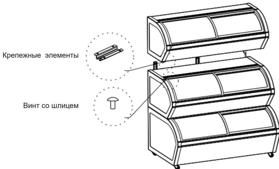
**Шаг 2:** Поместите верхний ярус на средний, выровняйте задние стенки, сдвиньте левый край примерно на 30 мм, чтобы направляющие на дне верхней части вошли в канавку на крышке нижнего яруса.
