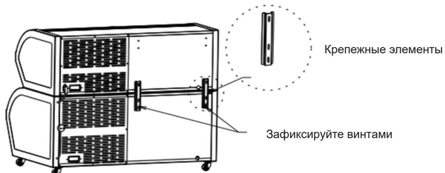
**Шаг 5:** Убедившись, что установка ярусов завершена, подключите шнур питания от нижнего яруса к среднему. Затем подключите шнур питания нижнего яруса к розетке, которая должна быть заземлена с напряжением 220 В / 50 Гц.
