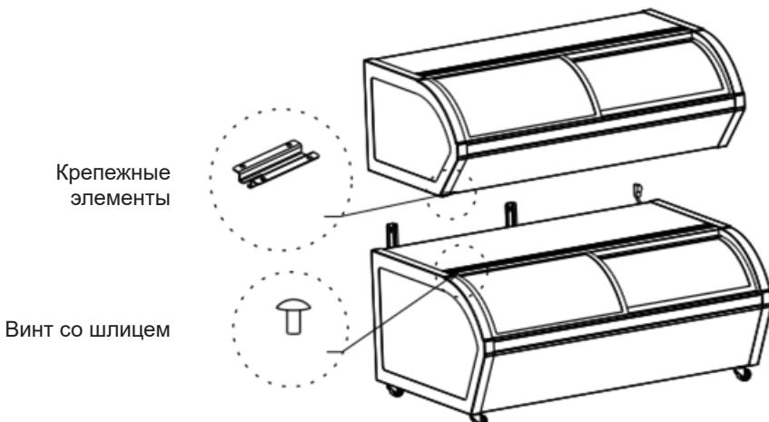
**Шаг 2:** Поместите средний ярус на нижний, выровняйте задние стенки, сдвиньте левый край примерно на 30 мм, чтобы направляющие на дне средней части вошли в канавку на крышке нижнего яруса.
